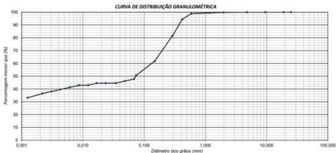
Figura 17 - Curva granulométrica da mistura AB.
