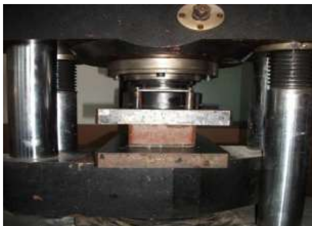
Figura 26 - Realização do ensaio de resistência à compressão simples.
