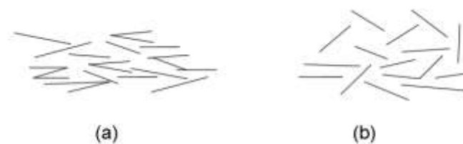
Figura 7 - Estrutura da argila: (a) dispersa; (b) floculada (KNAPPET E CRAIG, 2014).
