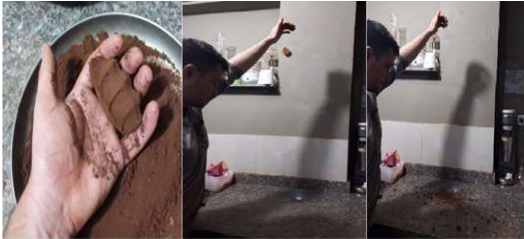
Figura 10 - Ensaio do bolo para verificação da umidade ideal.
