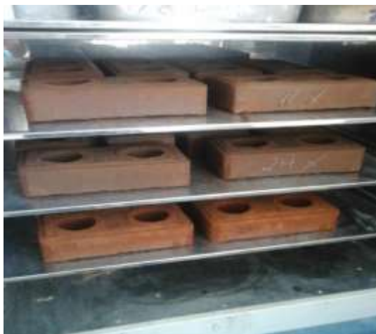
Figura 27 - Tijolos em estufa de circulação forçada.
