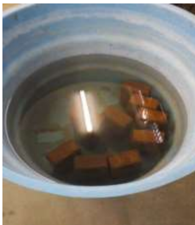
Figura 28 - Tijolos submersos para realização do ensaio de absorção de água.
