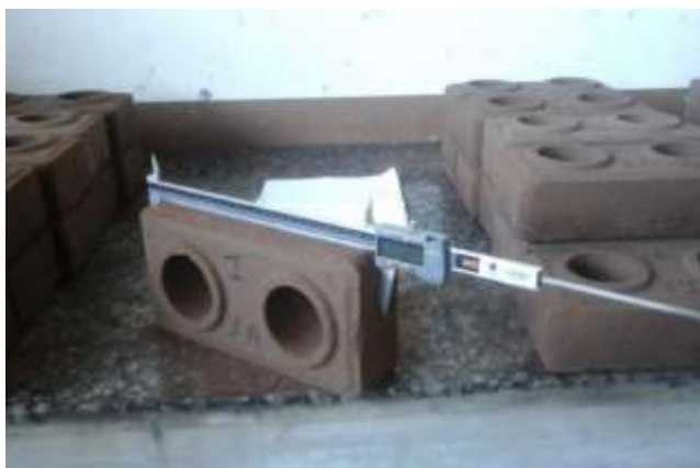
Figura 24 - Medição dos tijolos com paquímetro.
