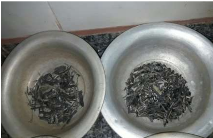
Figura 18 - Materiais grosseiros retidos nas peneiras de abertura 4,8 mm e 2,36 mm.
